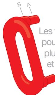
Les tiges sont d'abord plus étroites (A), pour faciliter l'insertion dans l'étiquette, puis plus larges (B), pour les « mettre à serrage » et ainsi éviter tout dépôt alimentaire.
